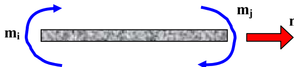
Figura 1.11 Esfuerzos generalizados en un miembro de un pórtico
